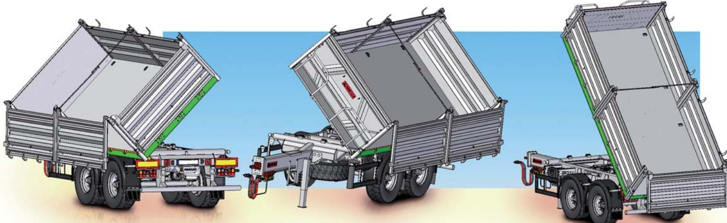
фото: использование гнутых профилей на бортах позволило укрепить их без приварки дополнительных укрепляющих элементов
