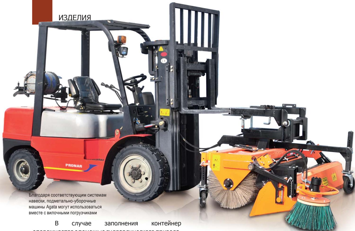
Благодаря соответствующим системам навески, подметально-уборочные машины Agata могут использоваться вместе с вилочными погрузчиками
