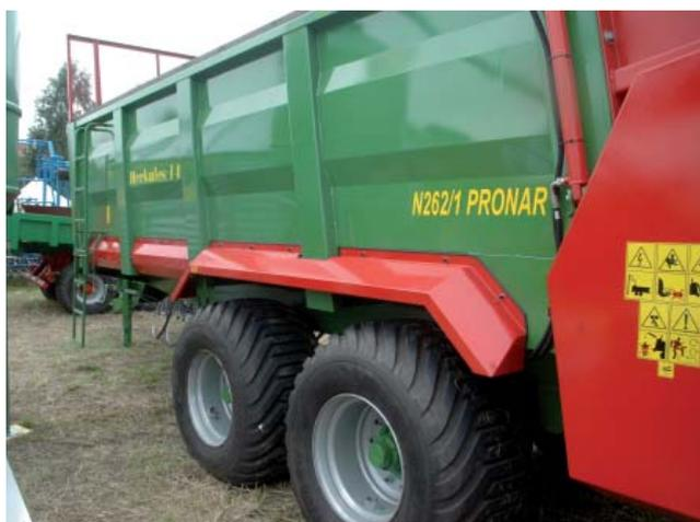
Разбрасыватель навоза Pronar с максимальной грузоподъемностью Herkules N262/1
