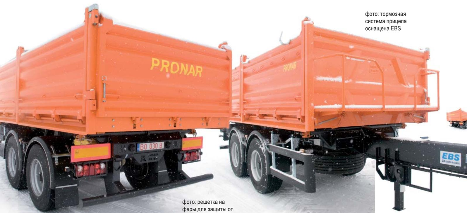
фото: тормозная система прицепа оснащена EBS
