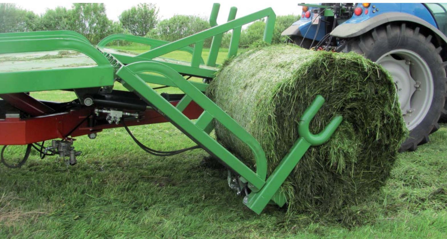
Захват и погрузка рулона. Управление осуществляется с помощью рычага из кабины трактора
