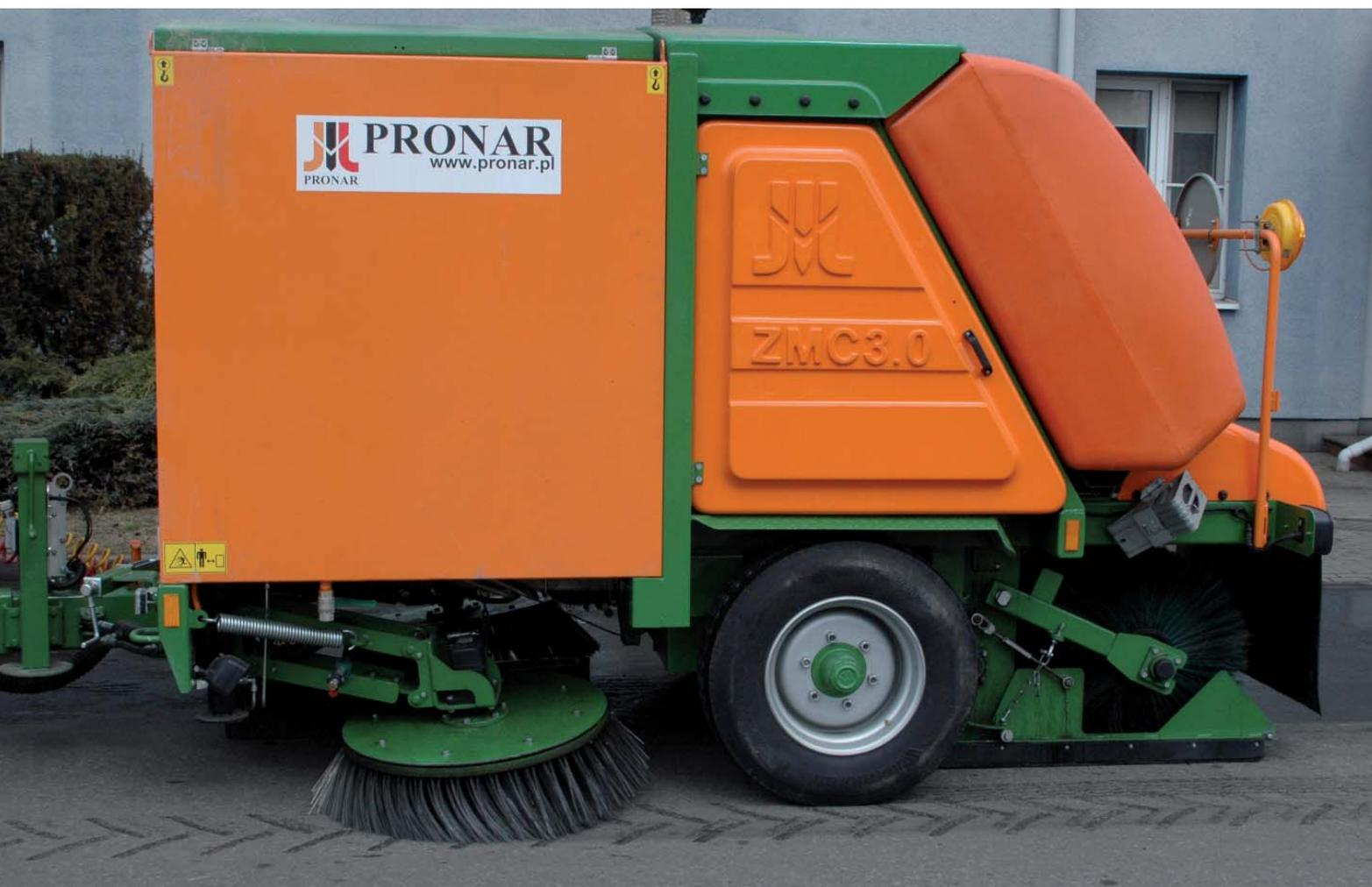
Чистящий блок подметально-уборочной машины ZMC 3.0 состоит из двух передних подметающих щеток и расположенной в задней части цилиндрической щетки
