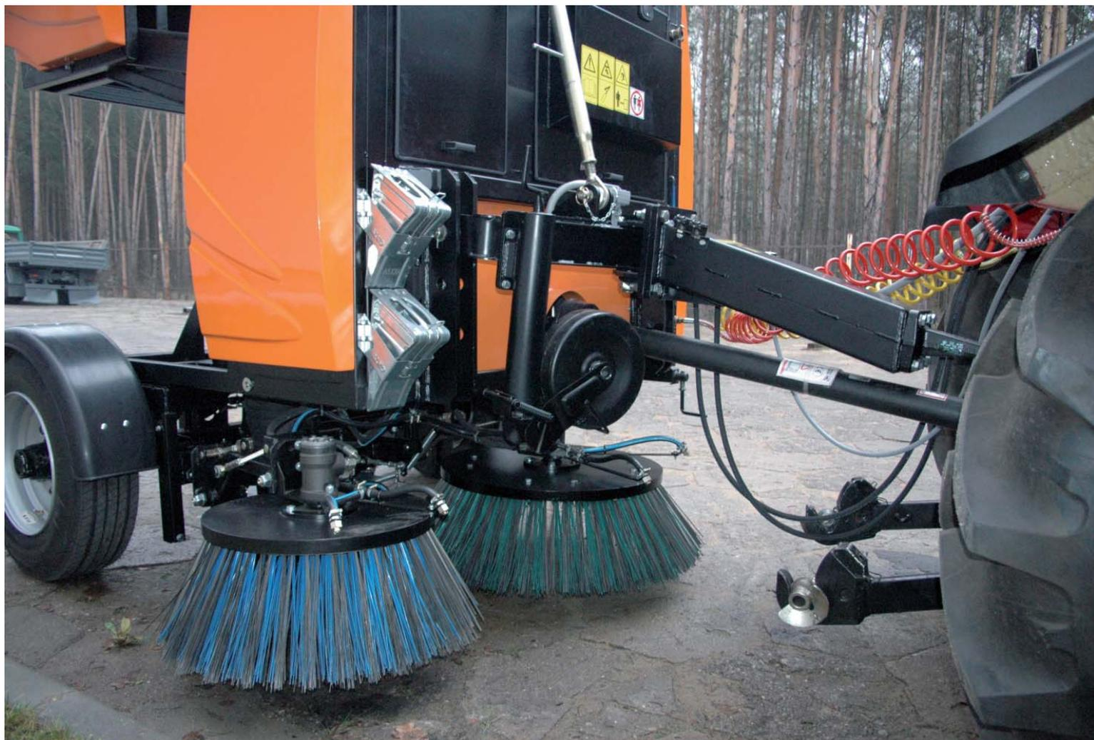
Чистящий блок подметально-уборочной машины ZMC 2.0 состоит из двух подметающих щеток и наконечника, всасывающего мусор
