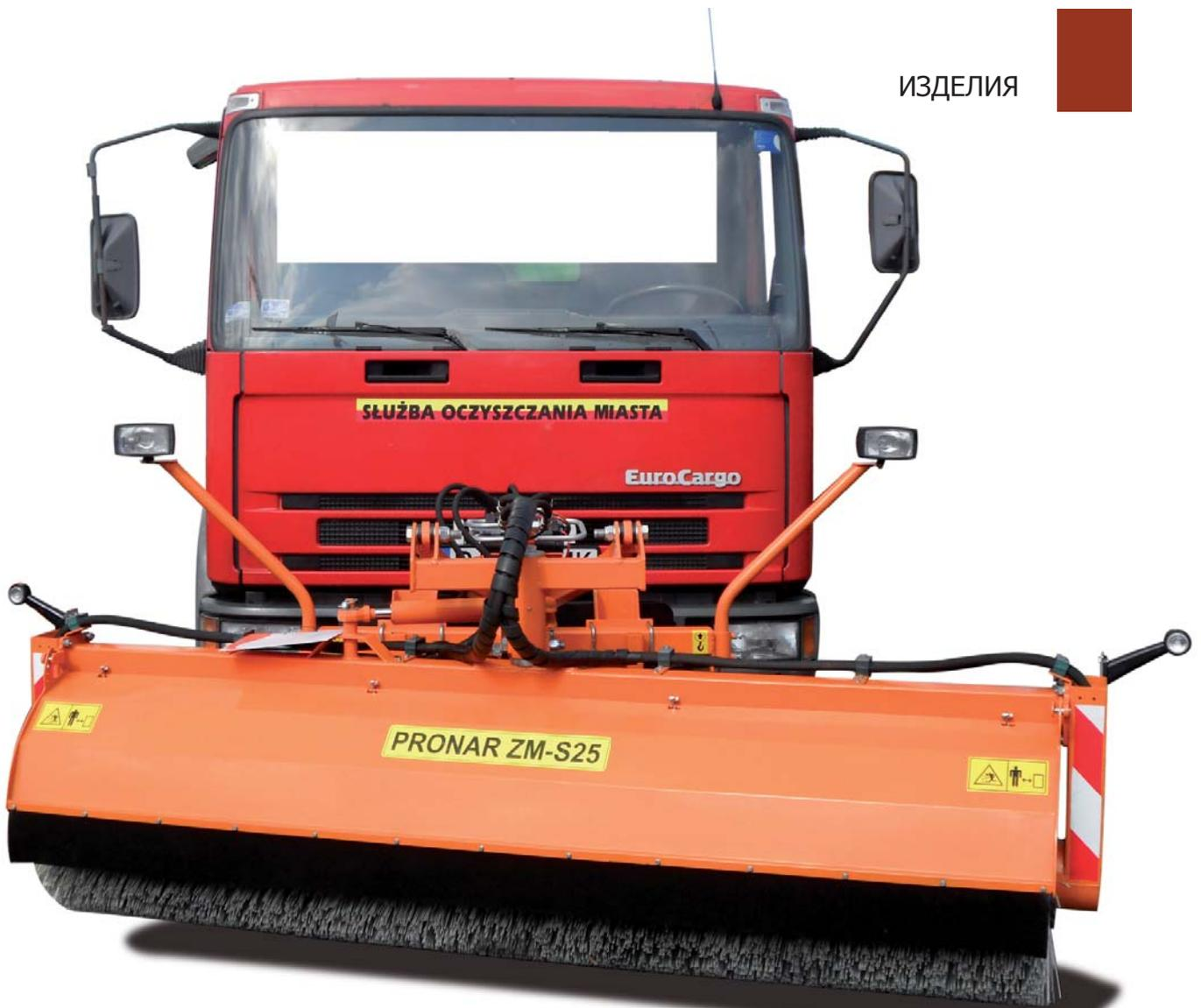
с электронным управлением, выполняемым из кабины оператора. Расход масла составляет 40 л/мин. Нажим щетки на поверхность ограничивается регулируемыми ходовыми колесиками. Стояночные опоры используются для размещения на них подметально-уборочной машины в то время, когда она отключена от носителя.
