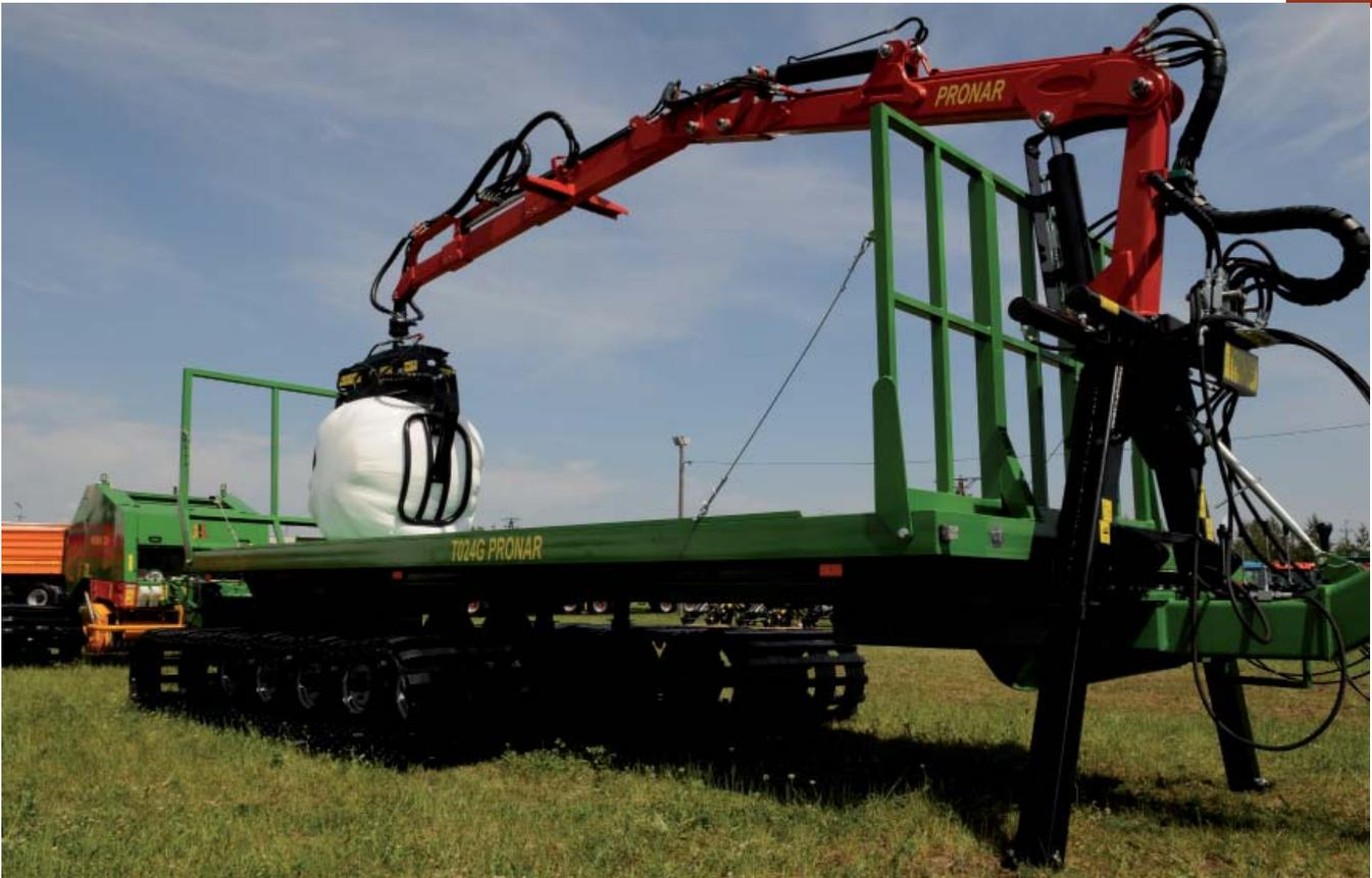
Погрузчик PRONAR ŁZP6900 можно агрегировать с разными прицепами, например, с PRONAR T024G, предназначенным для работы на подмокшей местности. Выдвижные опоры погрузчика обеспечивают ему стабильность
