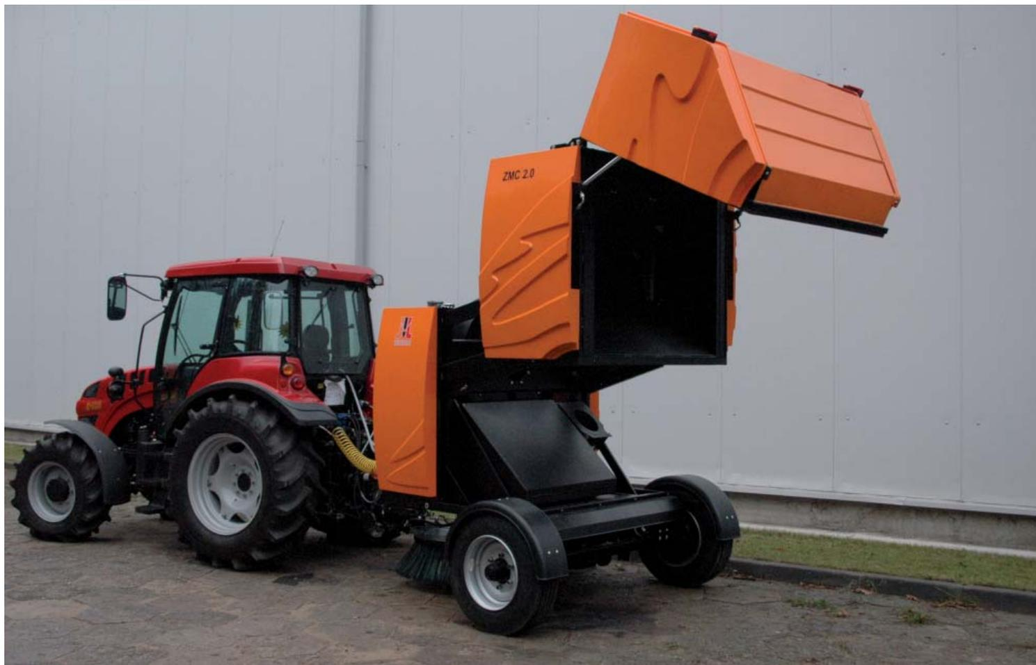
Опорожнение бункера с мусором подметальной машины ZMC 2.0 производится с помощью гидравлической системы посредством расположенного в кабине пульта
