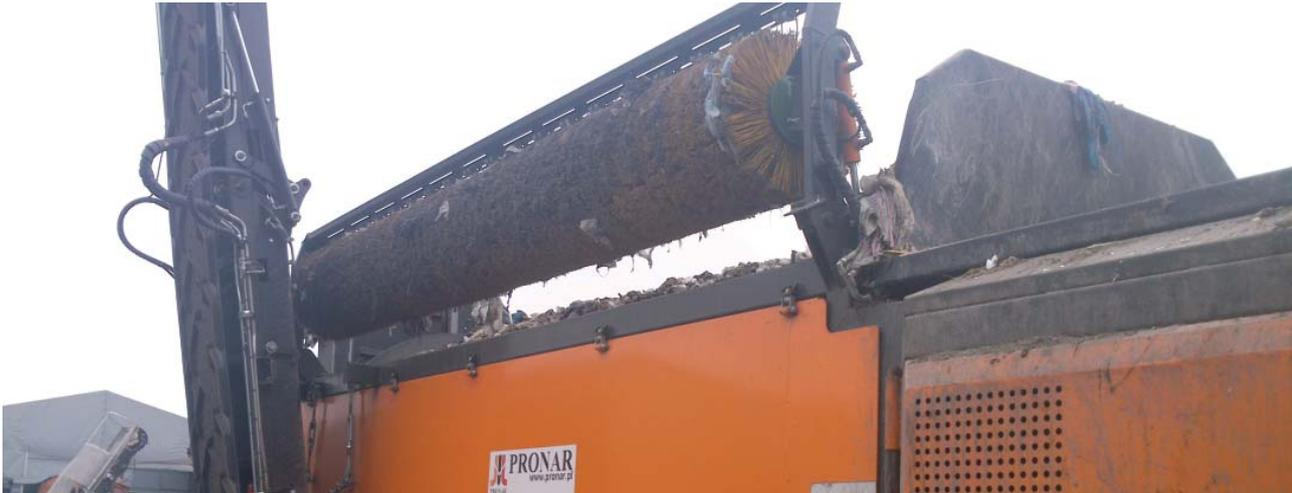
Щетка, расположенная над просеивающим барабаном, после опускания производит его очистку в процессе работы
